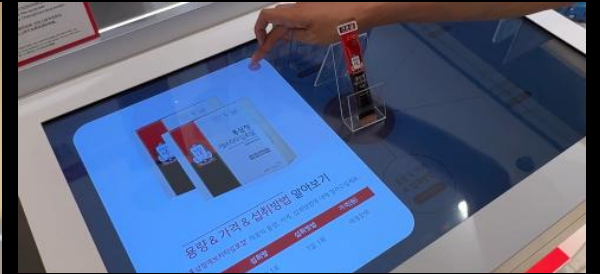
RFID Table : 전시된 제품을 스마트 테이블위에 올리면 사물인식 기술을 활용하여 제품의 상세 정보 제공 (한/영/중 다국어제공)
