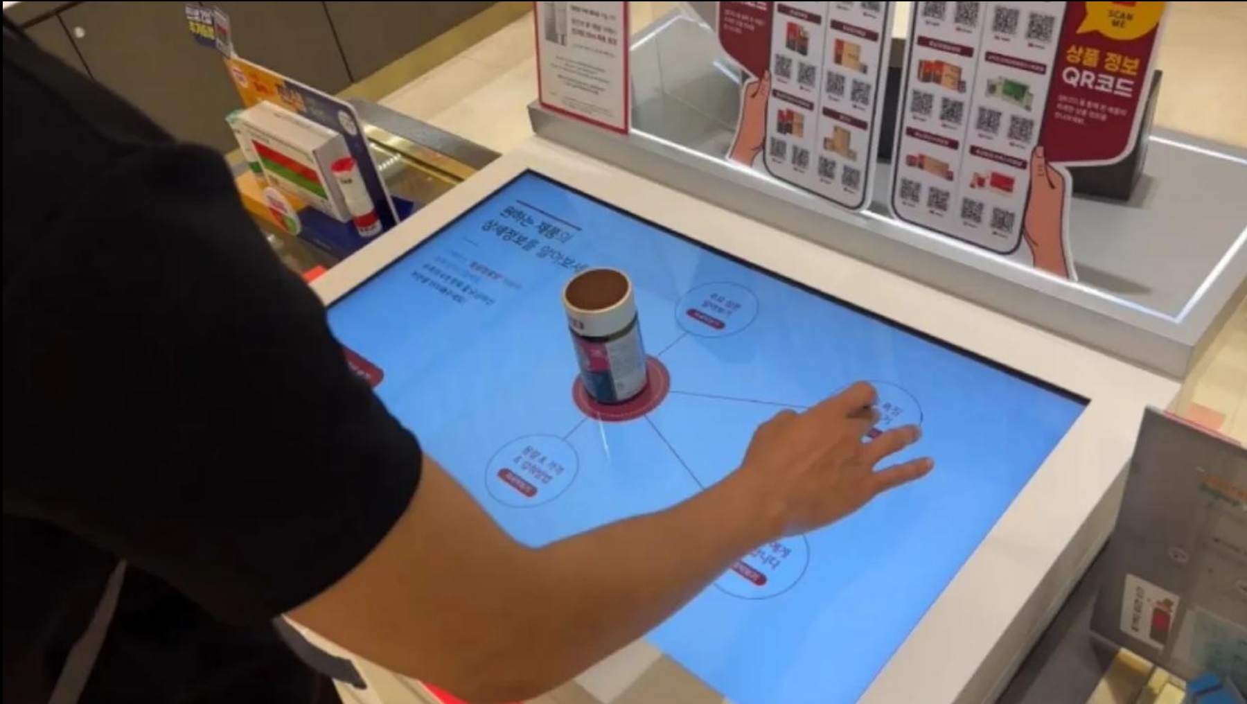
RFID Table : 전시된 제품을 스마트 테이블위에 올리면 사물인식 기술을 활용하여 제품의 상세 정보 제공 (한/영/중 다국어제공)
