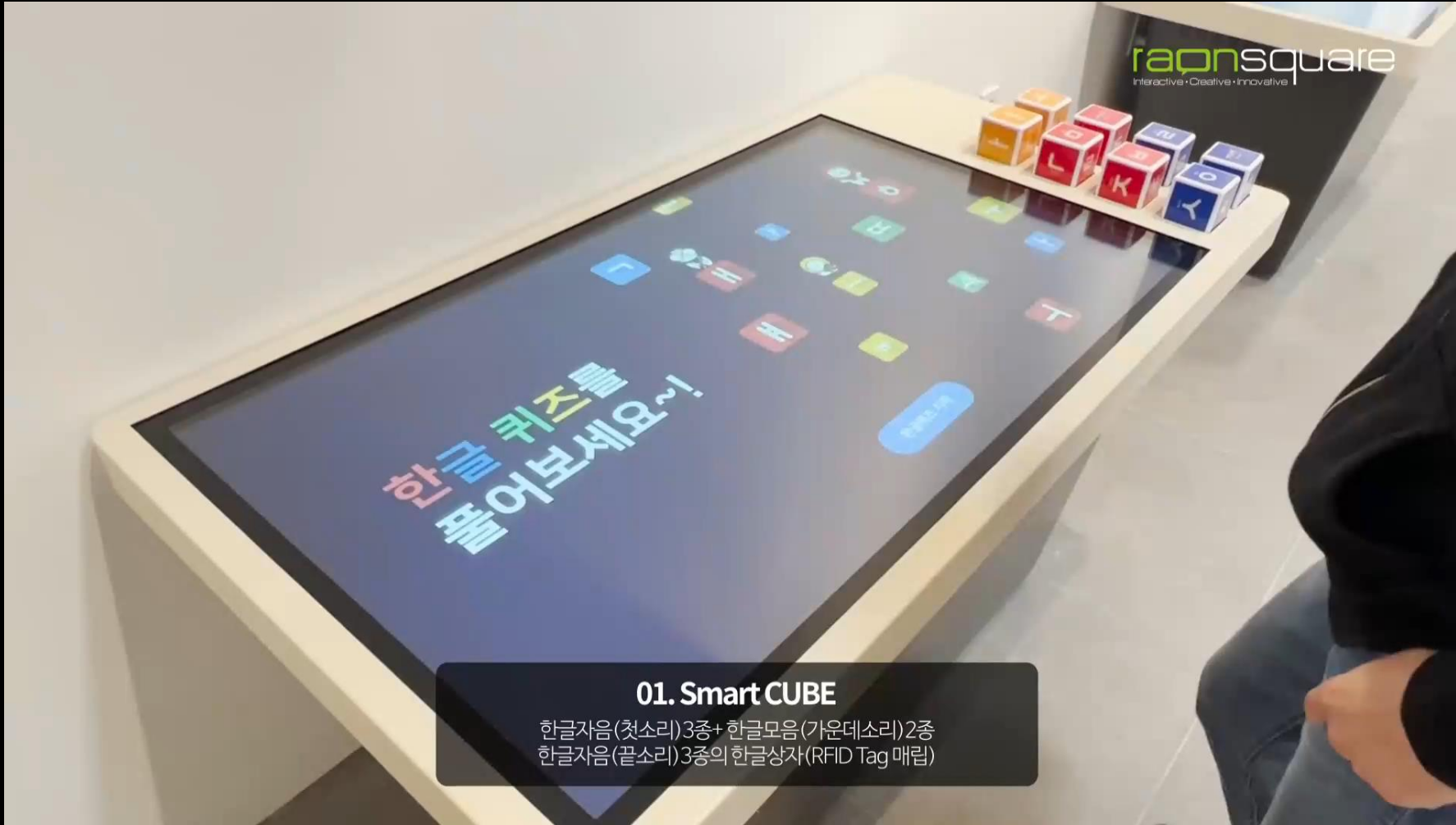
한글자음(첫소리) 3종 + 한글모음(가운데소리) 2종+ 한글자음(끝소리) 3종의 '한글큐브'로 구성 (RFID Tag 매립)
