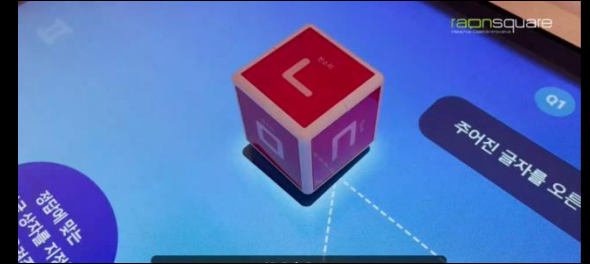
한글자음(첫소리) 3종 + 한글모음(가운데소리) 2종+ 한글자음(끝소리) 3종의 '한글큐브'로 구성 (RFID Tag 매립)
